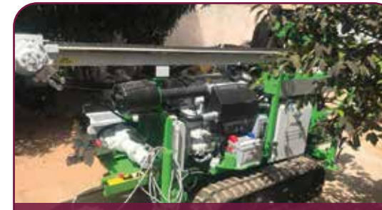
FOREUSE FORDIA 450: PROFONDEUR : 60m
